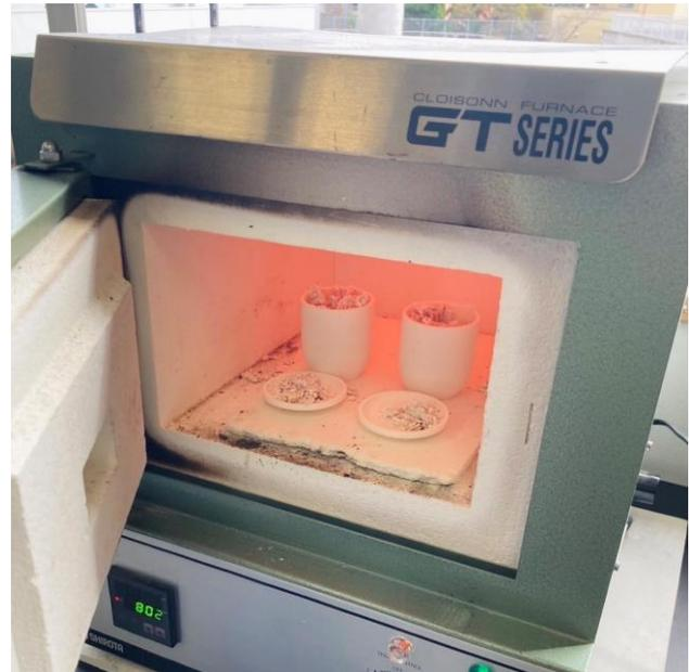
写真2：ヒトデを電気炉で焼いている工程
