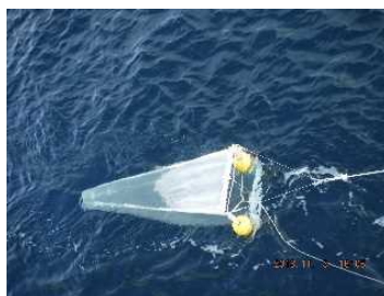
写真 2 ニューストーンネット曳航中
