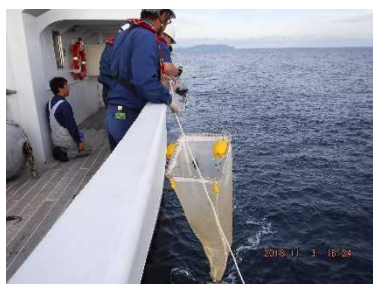
写真 1 ニューストーンネット投入時
