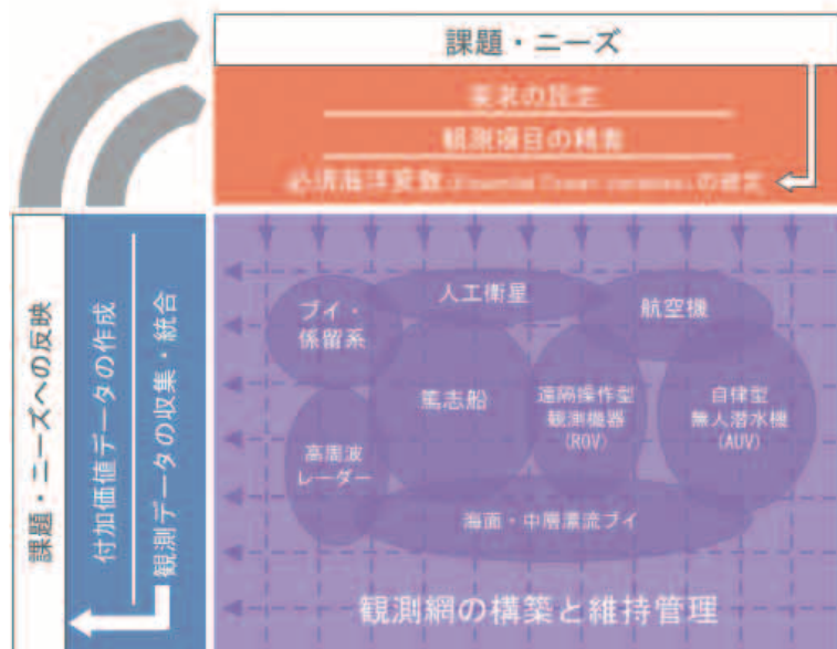
図5-2-3 統合的海洋観測推進のための枠組 (FOO: Framework for Ocean Observing) のプロセス概念図
