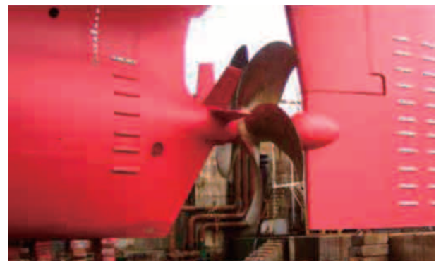
船舶の省エネ付加物装置「MT-FAST」（出典：常石造船）
