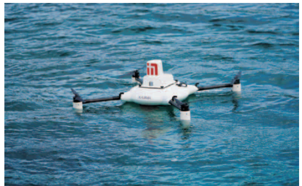
水面浮体型ドローン SWANS の着水状況 (出典: 鹿島建設)
