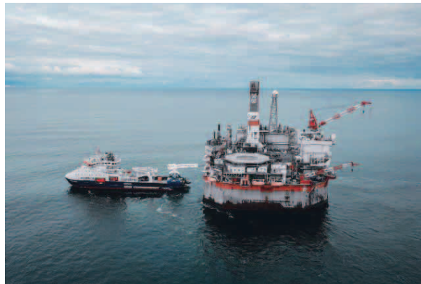
図3-1-5 動揺する洋上浮体間の人員輸送を行うギャングウェイ（Ampelman社 (注28) ）
