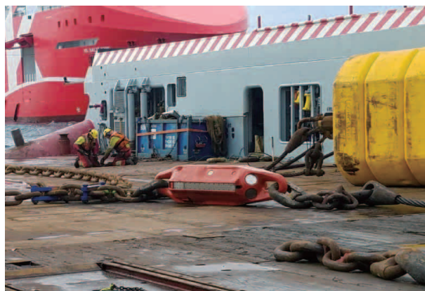
図3-1-6 緊急離脱システム（たとえば、Delmar切り離しシステム、RARPlus）
