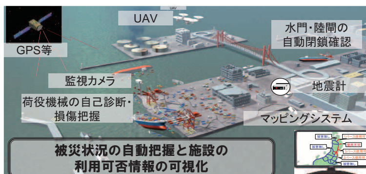
図3-3-15 IoT等を活用した被災状況の「見える化」による港湾機能の早期復旧
