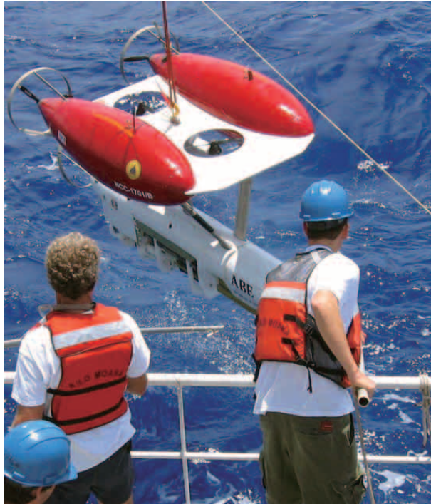
図1-2-22 ウッズホール海洋研究所 (WHOI) の AUV ABE (Autonomous Benthic Explorer) とマサチューセッツ工科大学 (MIT) の調査チーム (出典：WHOI ホームページ)
