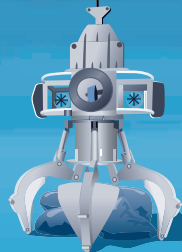
FPG (ファインダー付パワーグラブ) 海底鉱物などの試料を採取。
