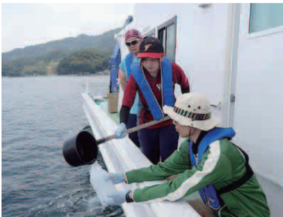
環境 DNA は、多少荒れた海でも採取可能。採水後、フィルターを付けた注射器で、DNA を含む有機物をこし取る。写真は、京都大学舞鶴水産実験所の調査船緑洋丸での環境 DNA 採取（2016 年 6 月、益田玲爾氏撮影）
