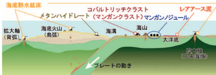
図1-3-2 日本周辺の深海に存在するエネルギー・鉱物資源の地質断面分布(注58)。
