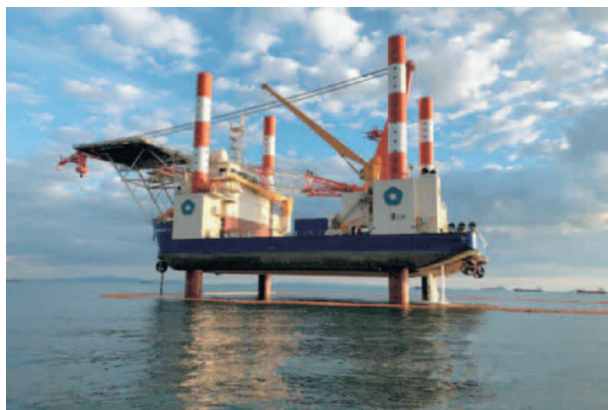
図1-1-4 五洋建設(株)の洋上風車開発専用船「CP-8001」 (出典：GustoMSC社のウェブサイト)
