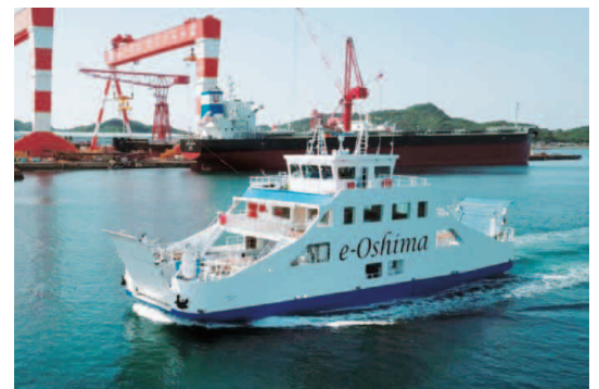
完全バッテリー駆動船「EV e-Oshima」 （出典：（株）大島造船所）
