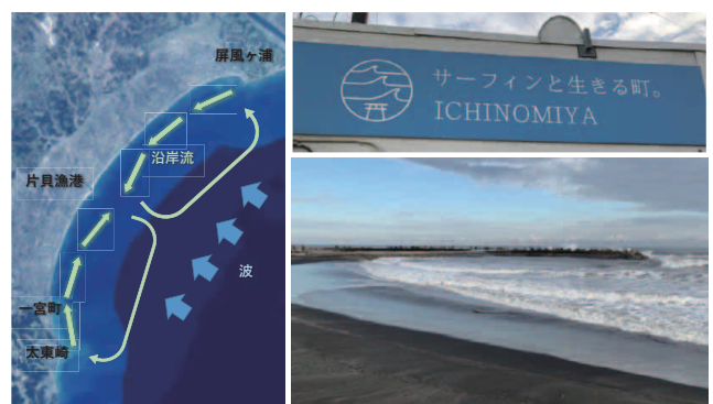
図 九十九里浜の循環の模式図（左）と上総一ノ宮駅前の看板（右上）、一宮海岸のT字堤（ヘッドランドHL） （出典：筆者作成・撮影）
