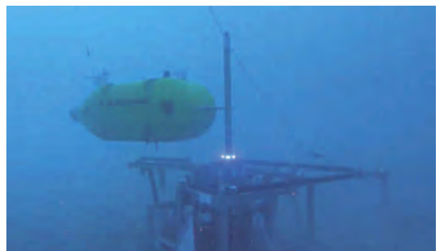
AUV 海中充電の実用化に向けた試験 この実用化により、海底探査効率が格段に向上することが期待される。
