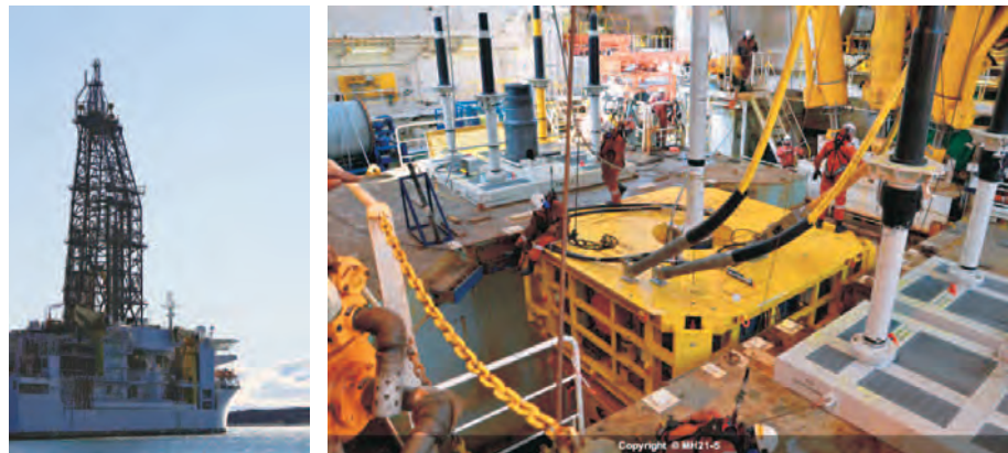
図3-2-1 地球深部探査船「ちきゅう」(左)とその船上でメタンハイドレート海洋産出試験のための海底設置機器を海底に降下するための最終確認の様子(右)
