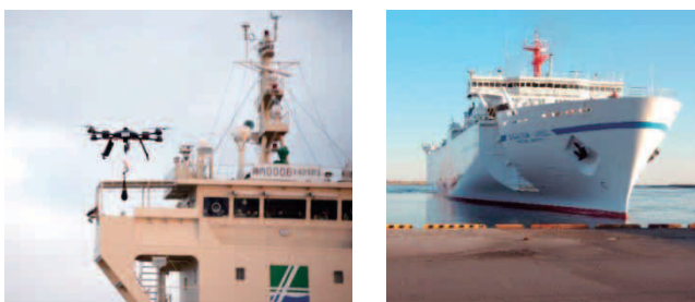
図4 「みかげ」の着棧時にヒービングラインを運ぶ無人ドローンと大洗港に自動着棧する「さんふらわあ しれとこ」
