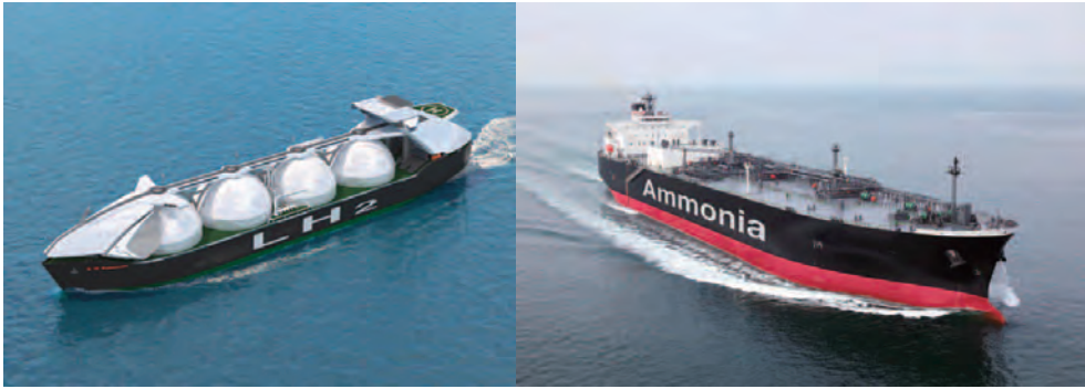
図1-3-3 大型液化水素運搬船（左）とアンモニア燃料アンモニア輸送船（右） （出典：川崎重工(株)（左）、日本郵船(株)（右））
