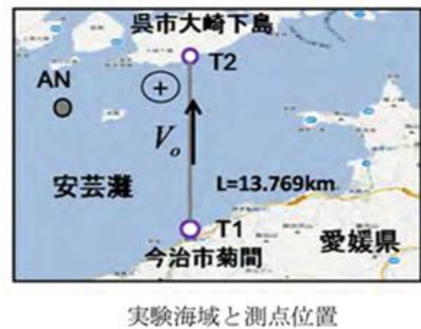
図8 沿岸音響トモグラフィの概要 (出展 参考文献9))
