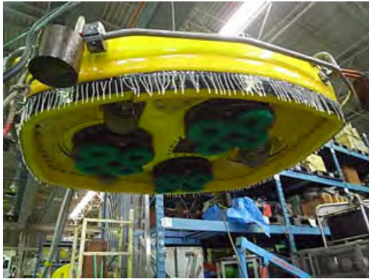
糸状吹き流し設置状
