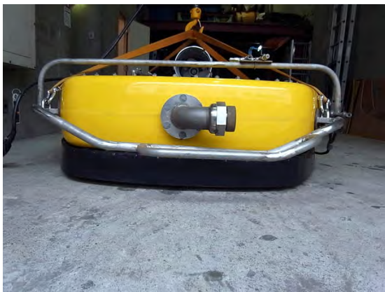
拡散防止ガード装着後（側面）
