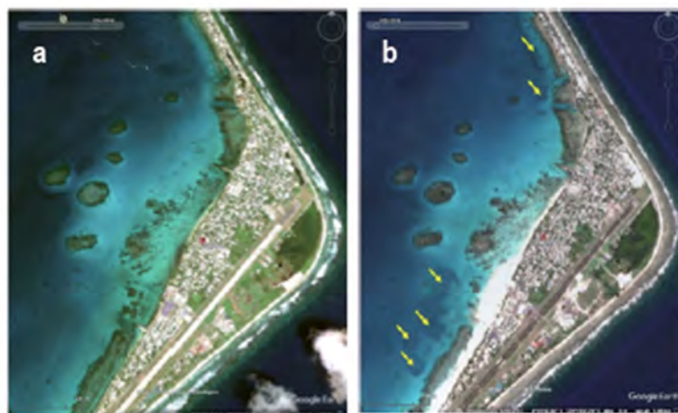
図 10：ボローピット埋め戻し用のラグーン浚渫の前後
