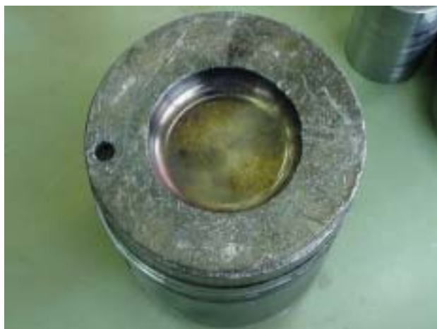
図 5 - 1 4 ピストン上部の損傷
