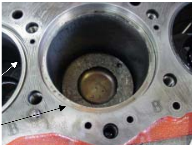
図 5 - 9 シリンダーとピストンの損傷
