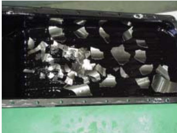
図 5 - 1 2 シリンダーライナーの損傷
