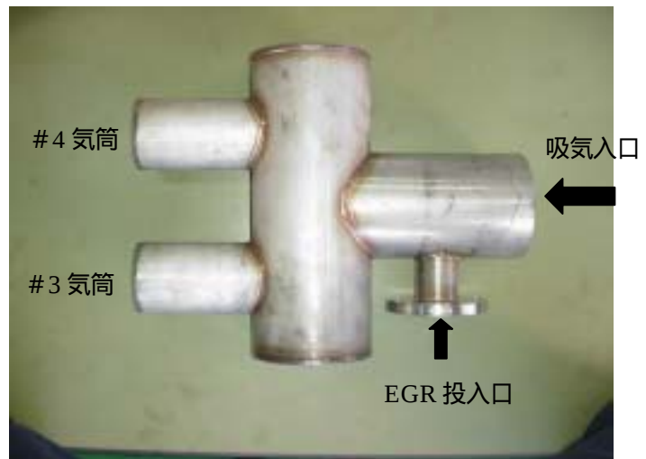
図 5 - 1 5 EGR 配管の外観
