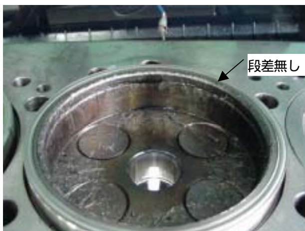
図 5 - 10 ヘッドライナーの損傷
