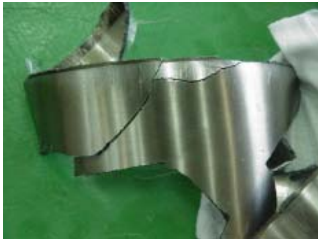
図 5 - 1 3 シリンダーライナー上部の損傷
