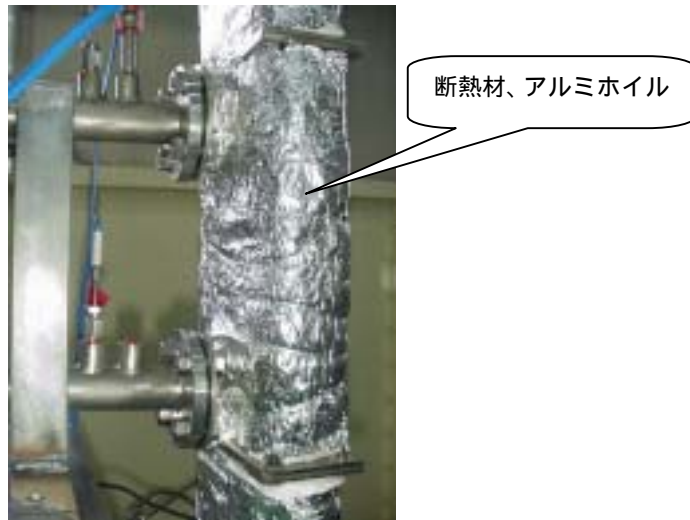
図 7 - 9 断熱材を巻いた熱交換器本体の外観図
