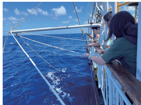
プランクトンネットを曳航してマイクロプラスチックを採取
