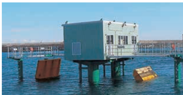
「フラップゲート式可動防波堤」の実海域試験
