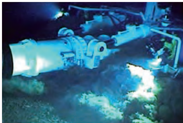
図3-3-5 海底を走行する採掘試験機
