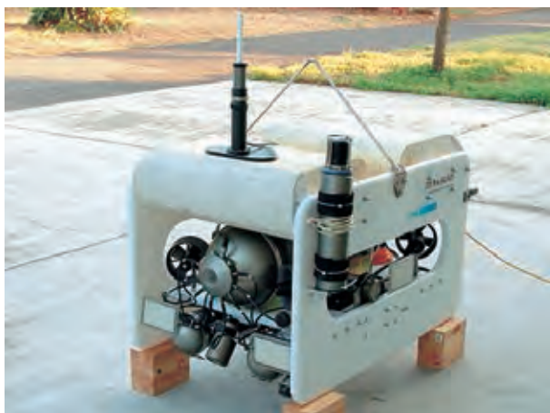
自律型海中ロボット「Tuna-Sand」
