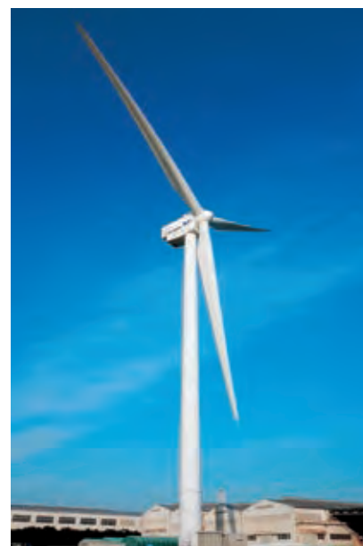
世界初の油圧ドライブを搭載した三菱重工風車 (出典：三菱重工業ホームページ、 http://www.mhi.co.jp/news/story/1301245310.html )
