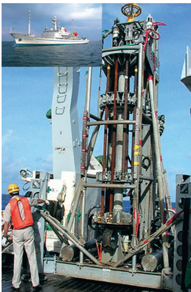
図2-1-5 鉱物資源探査専用船「第2白嶺丸」(左上)に搭載された海底着座型ボーリングマシン
