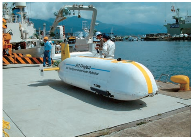
図5-1-2 東京大学生産技術研究所の浦教授が開発した4000 m級 AUV
