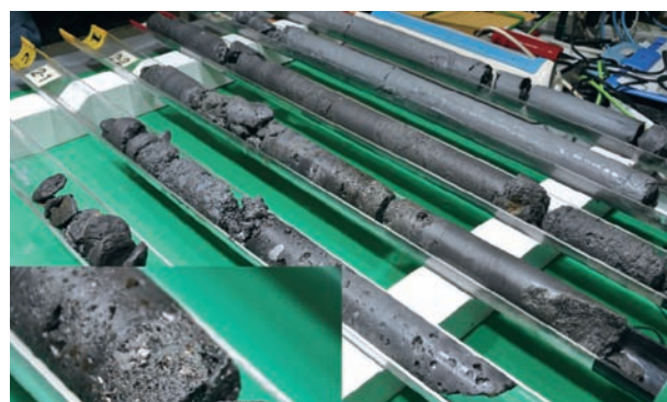
図2-1-6 資源量評価調査(ボーリング調査)で取得した柱状コア例
