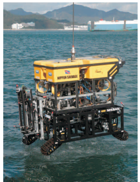
今回海中試験を行った高効率海中作業システム (出典：JAMSTEC)
