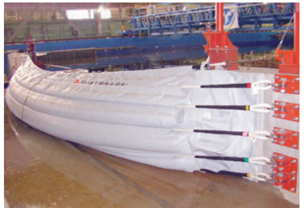
図2-22 高潮対策用の膜式防波堤「シティバリア」
