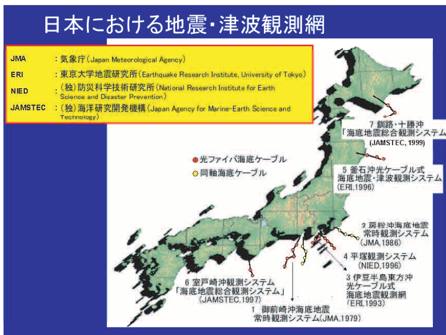
図4-3-4 日本近海の地震・津波観測網 (海洋研究開発機構北沢一宏氏提供の図をもとに加筆修正)
