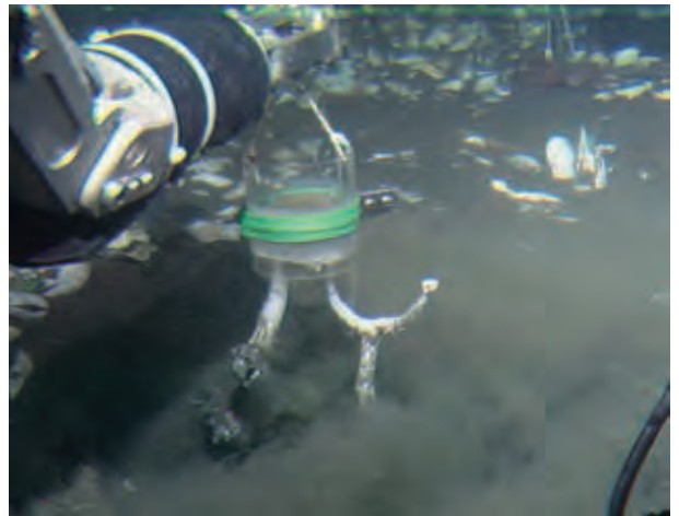
深海底に生息する大型生物の巣穴構造の調査 写真のような枠を海底に設置し樹脂を単穴に挿入して型をとる (画像提供：JAMSTEC)
