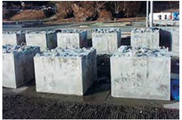
震災のがれき利用の漁礁ブロック
