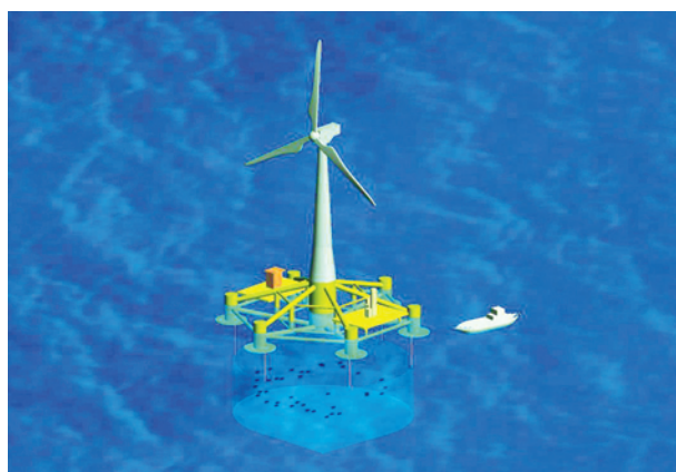
図5-2-4 浮体式洋上風車基礎の漁業協調のアイデア (出典：日立造船(株)提供資料、2011)
