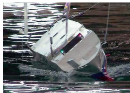
実海域再現水槽での船体傾斜実験
