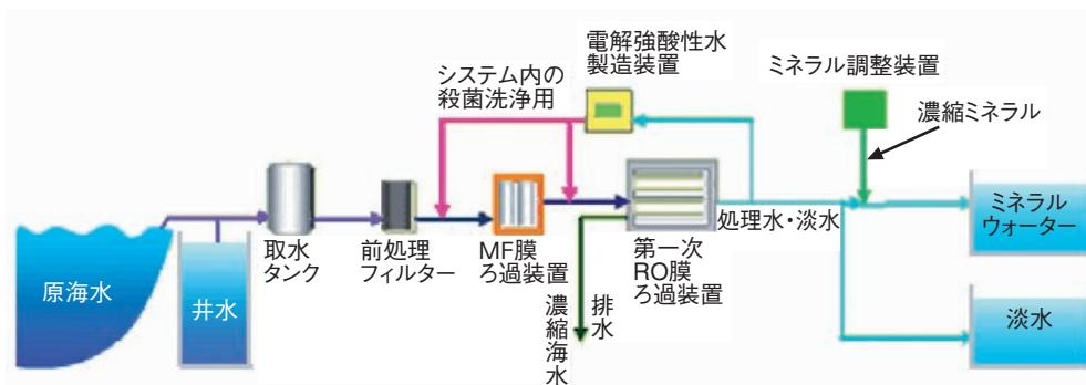
図2-11 海水淡水化システム（提供：株弁天）
