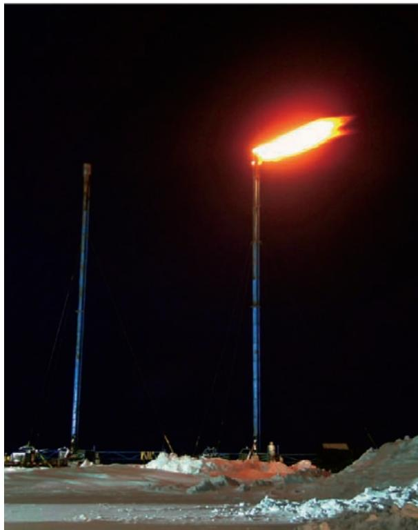
図2-12 分解したメタンガスを燃焼させたフレア
