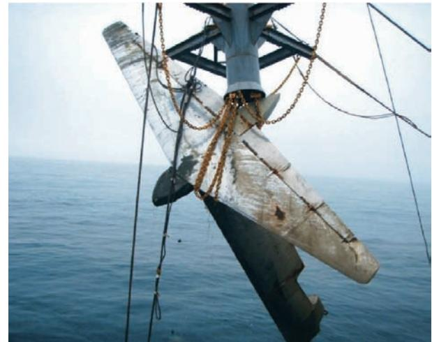
図2-25 網チェーン式回収装置（提供：(独)港湾空港技術研究所）
