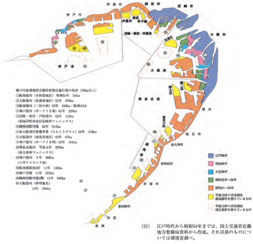
図2-1-2 人工海岸の多い大阪湾奥部における埋立状況 (出典：瀬戸内海の環境保全 資料集)
