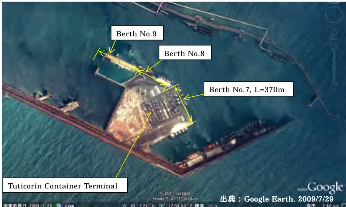
写真 5.9-4 コンテナターミナルの配置写真 (2009 年 7 月現在)
