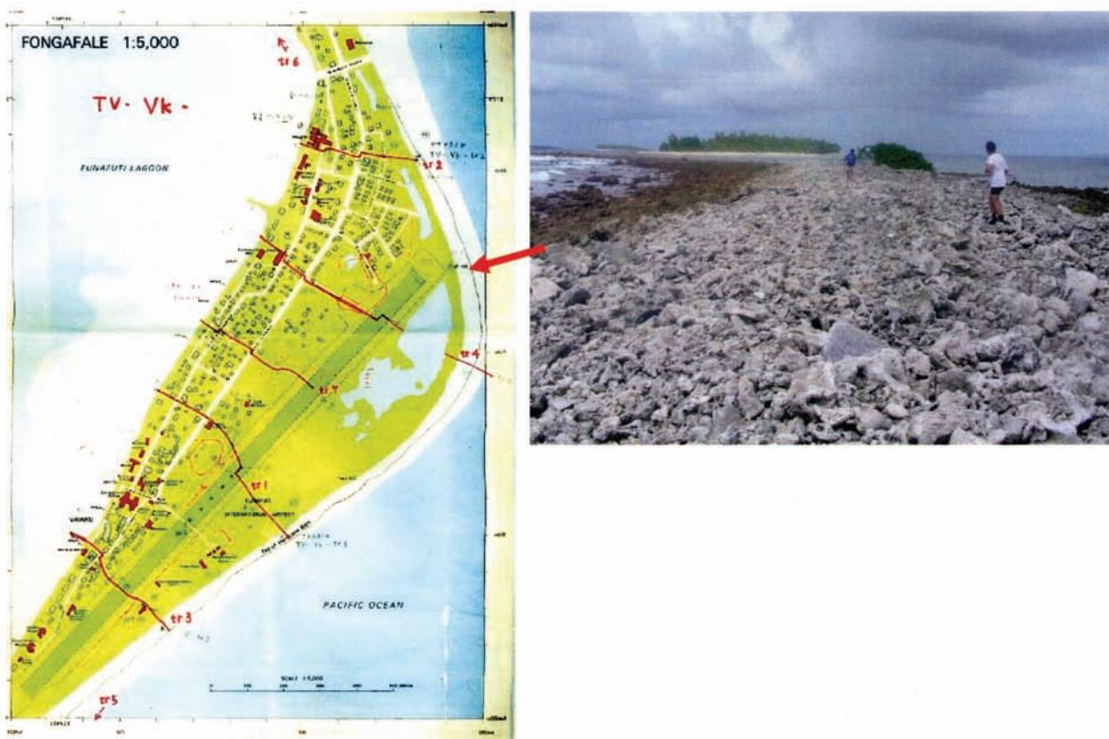
図4 フナフチ環礁のハリケーンリッジ。台風通過の際に打ち上げられた大量のサンゴ礫によって、高さ4m、総延長19kmのリッジが一晩で形成された。
