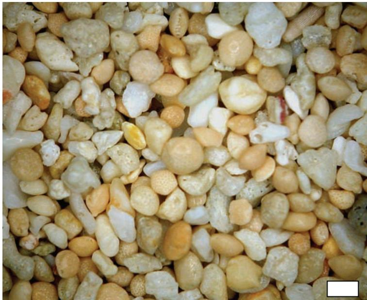
写真2. サンゴ礁洲島を構成する砂粒子の顕微鏡写真
