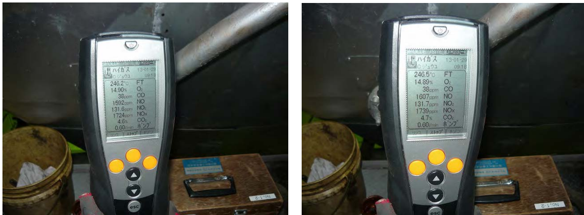
図 2.4-3 有害ガス濃度計測状況
