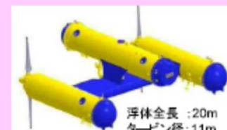
浮体全長:20m タービン径:11m 100kW水中浮遊式海流発電 「かいりゆう」
