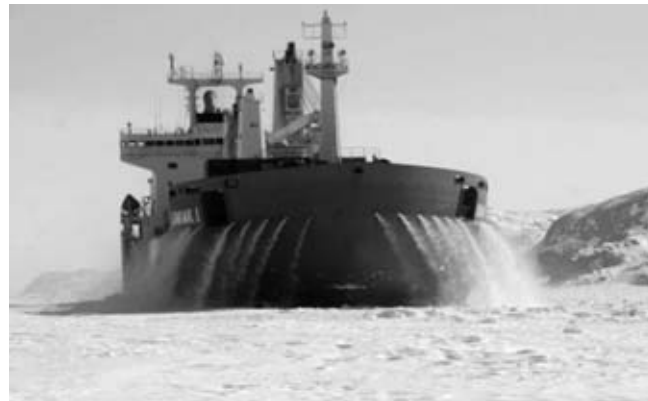
図 13 砕氷貨物船 UMIAK I : 通常プロペラ、散水装置装備、カナダ北方海域にて運航 (ユニバーサル造船提供)
