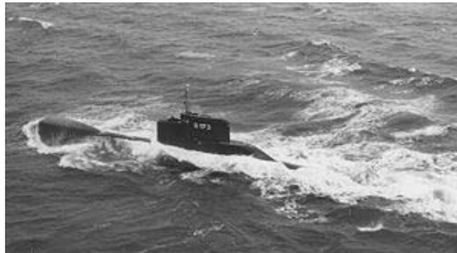
備考 : U-206 A (主要要目 : 排水量 450 (水上) / 500 トン (水中)、速力 10 ノット (水上) / 17 ノット (水中)、航続距離 4,500 カイリ (水上、6 ノット)、228 カイリ (水中、4 ノット)、兵装 : 533 ミリ魚雷発射管 8 門、魚雷 8 本 または機雷 16 個)
