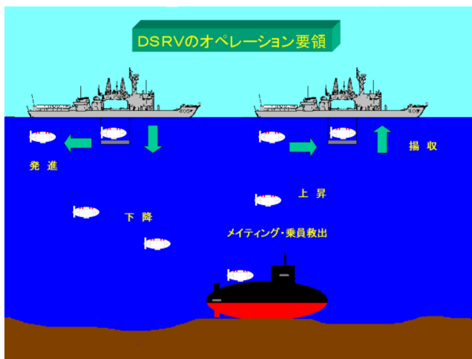
DSRV による潜水艦救難作業の流れ（海上自衛隊提供）
