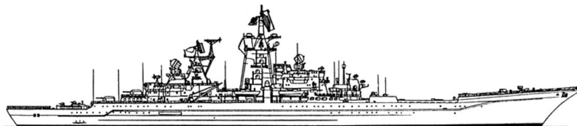
図 4 「プロジェクト 1144」原子力ミサイル巡洋艦「キーロフ」 満載排水量—24300t、最大長—251m、最大速力—31kt、主要兵装—対艦ミサイル 20 基
