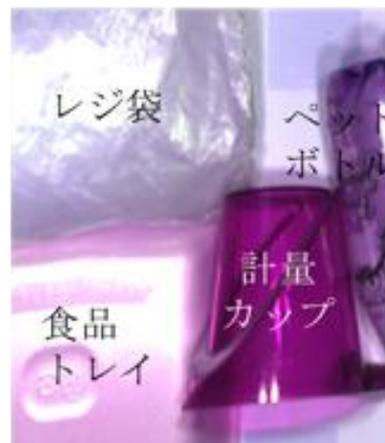
図 2.1.15 近赤外カメラによるプラスチック種の判別実験例
