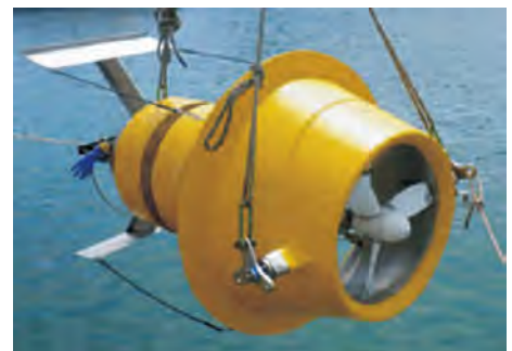
浮沈式潮流発電装置（出典：長崎大学）
