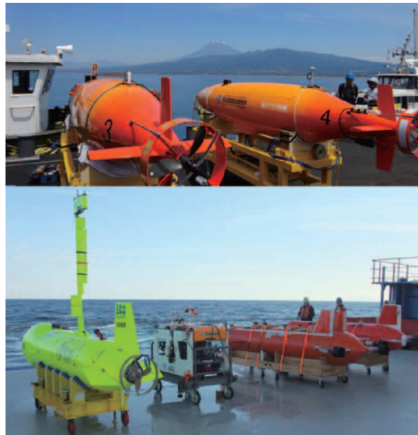
図1-2-24 海上技術安全研究所のAUVおよび洋上中継器(ASV) (上: 左から航行型AUV 3、4号機/下: 左から洋上中継器(ASV)、 ほばりん、航行型AUV 1、2号機)
