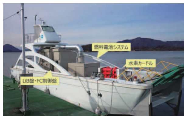
水素燃料電池の実験船（出典：海上技術安全研究所）
