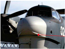
機首のスプレーストリップ と波押え板
