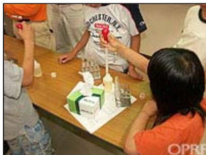
です。海水中のリン酸は、モリブデン酸を加えると黄色、さらにアスコルビン酸を加えると青色に発色します。その濃さを測定して、リン酸濃度を測定するしくみです。ここで使用した測定器は講師の手作り品で、1000円程度で製作可能とのこと。何らかの原因で試料が発色しなかった班もありましたが、講師には成功例のビデオも用意していただけ、不測の事態を補うことができました。
