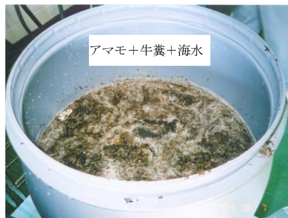
写真5. 2. 7 実験条件Bの腐敗タンク
