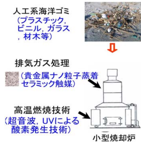
図5. 2. 1 小型焼却炉の概念図
