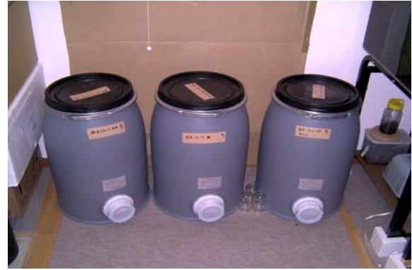
写真5. 2. 9 東宏研究室内の腐敗タンク
