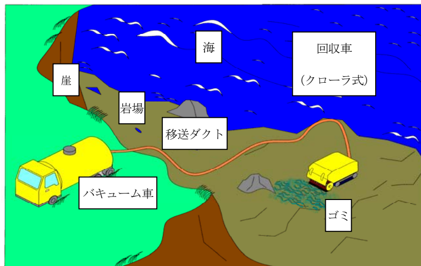
図 5.1.2 クローラ式の回収車+バキューム
