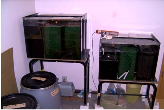
写真5. 2. 8 海草の微生物分解処理実験装置
